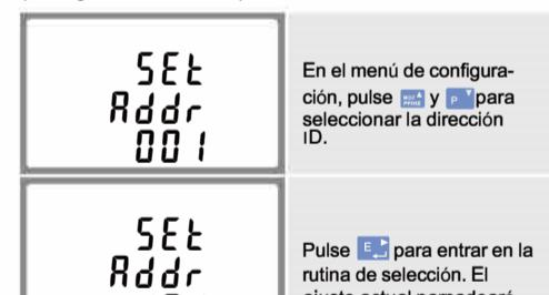
En el menú de configuración, pulse **MENU** y **P** para seleccionar la dirección ID.
